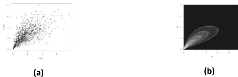
Gambar IV.1. (a) Perilaku Kegagalan Pertama (1000 observasi) dan (b) Kontur Densitas Distribusi Bivariat Weibull Lu-Bhattacharyya
